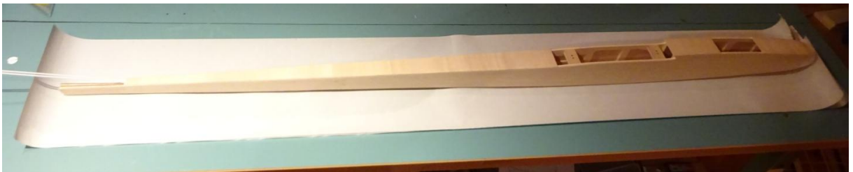
31. Die Folie für den Rumpf wird zugeschnitten.
