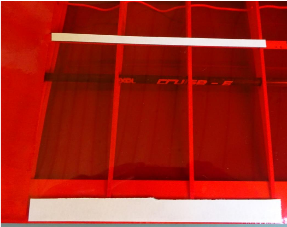
48. Das doppelseitige Klebeband wird auf die Endleiste (unten) und auf die zusätzliche Leiste (oben) geklebt, die aus diesem Grund eingebaut wurde
