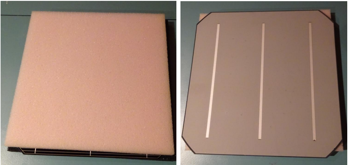
47. Umdrehen einer Solarzelle zwischen zwei Schaumstoffelementen. Die silbrigen Streifen sind negativen Pole der Zellen auf der Rückseite.
