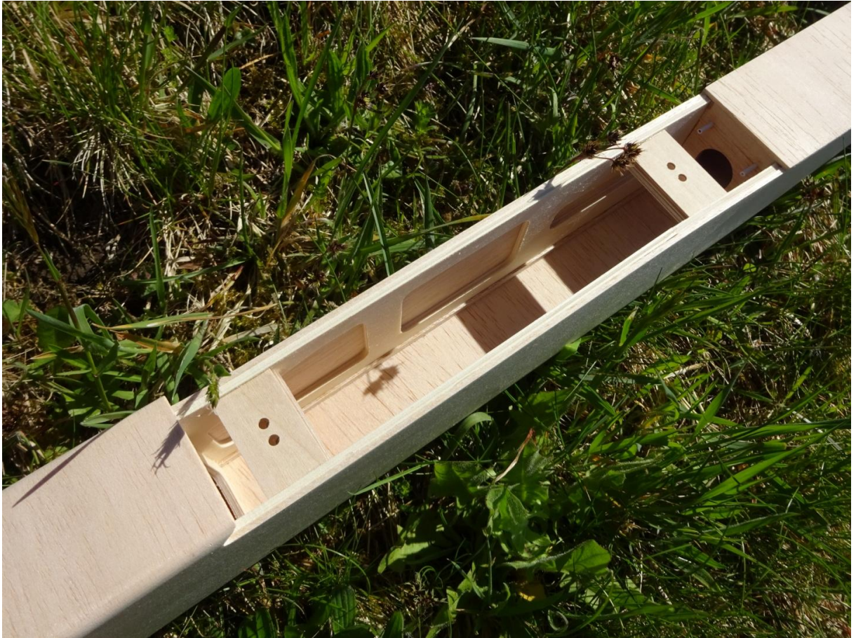
16. Der Bereich der Flügelaufnahme auf der Oberseite des Rumpfes
