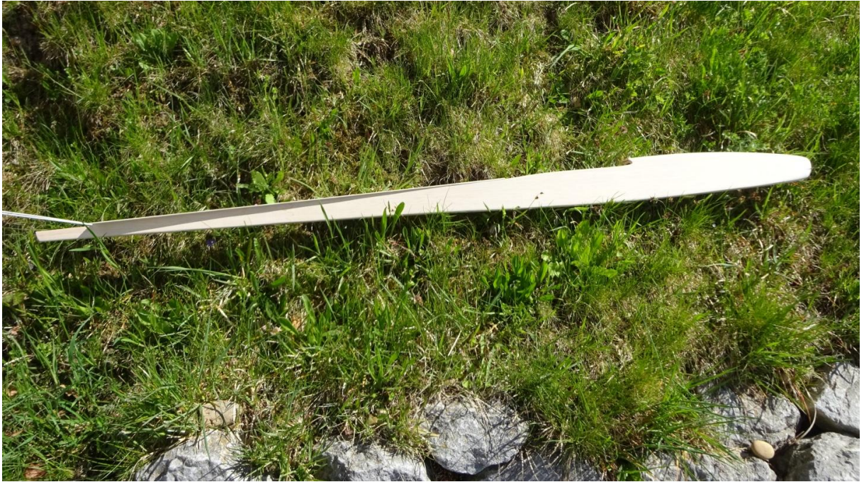
14. Die aufwändigste Arbeit am Rumpf ist das Verschleifen. So sieht das Resultat aus.
