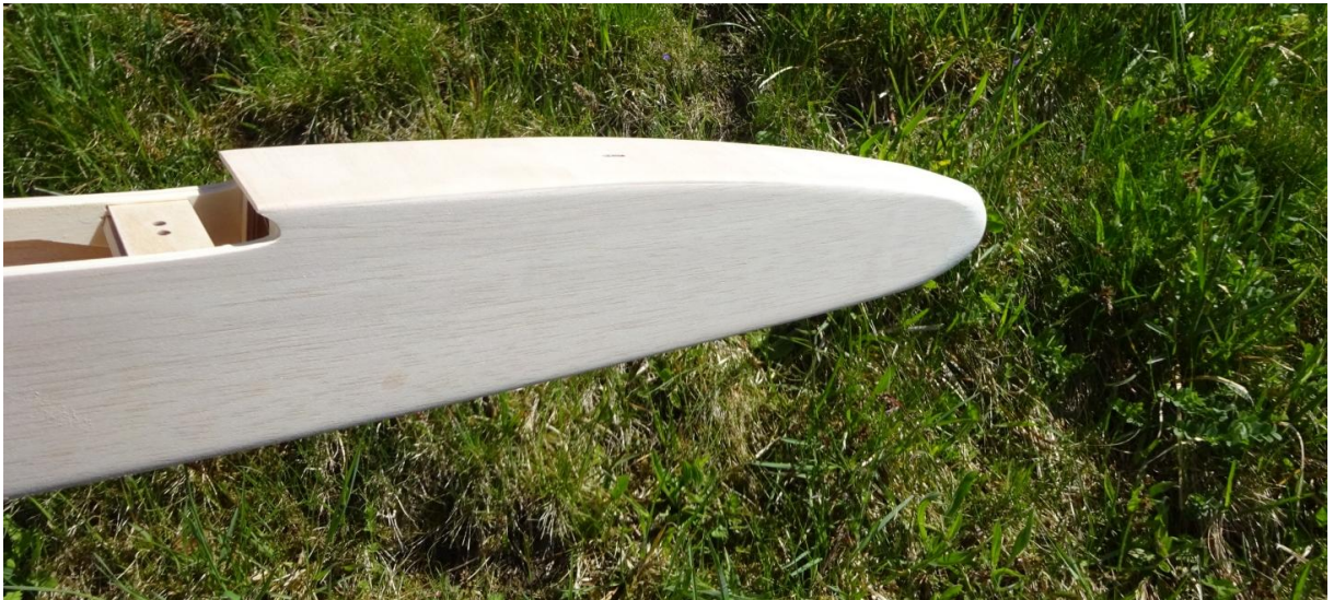
15. Detailaufnahme der Rumpfnase nach dem Schleifen
