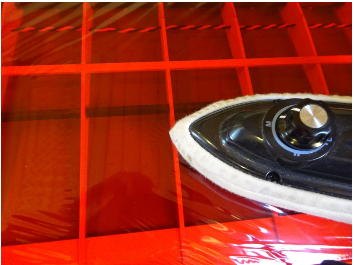
38. Die Folie wird erst auf den Rippen festgebügelt und dann mit dem Heissluftgebläse gespannt.
