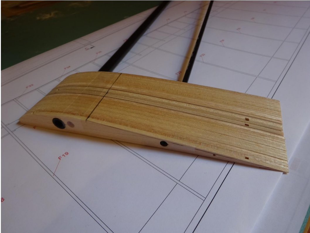
Abb. 40: Die fertigen neuen Rippen
