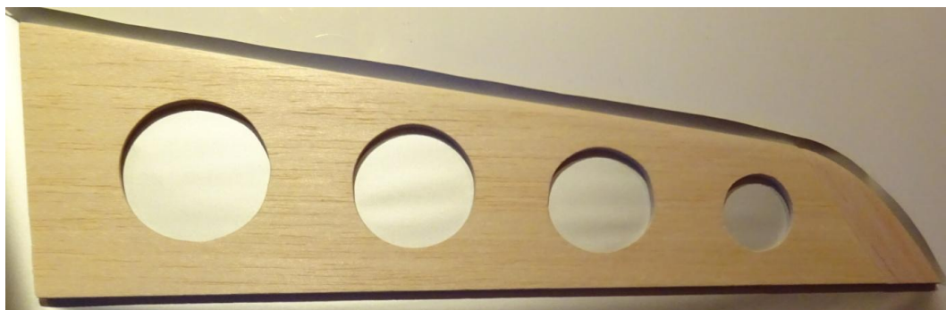
Abb. 41: Aussparungen im Leitwerk
