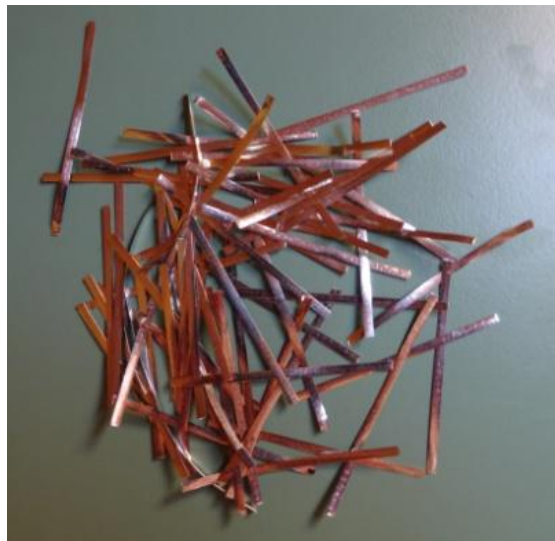
Abb. 37: Zugeschnittene Stücke des Lötverbinders
